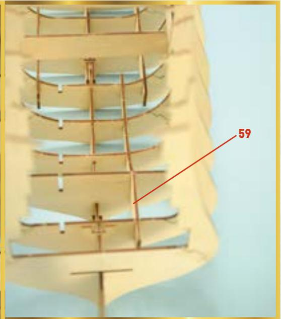
**4** Две детали (59) являются днищевыми стрингерами модели, расположенными рядом с килевой рамкой. Вклейте одну из этих деталей в пазы десятого, одиннадцатого, двенадцатого, тринадцатого и четырнадцатого шпангоутов, руководствуясь фотографиями.
